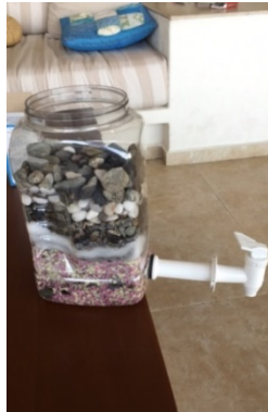
(Filtro de grava, foto; Febrero, 15, 2017)
