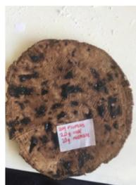
Figura 4. Muestra agregando 20g de  $C_8H_{10}N_4O_2$  (café), 20g de  $KAl(SO_4)_2$  (Alumbre de potasio) y 20g de plumas en la solución de 100ml de NaOH a 2 M.
