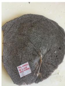
Figura 5. Muestra agregando 20g de  $C_8H_{10}N_4O_2$  (café), 20g de  $KAl(SO_4)_2$  (Alumbre de potasio) y 40g de plumas en la solución de 100ml de NaOH a 2 M.
