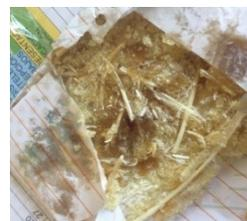
Figura 7.. Muestra de 20ml de  $H_2O_2$  (peróxido) con 20g de plumas disuelto de 100ml de una solución de NaOH a 2 M.
