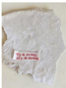
Figura 6.. Muestra de 20g de  $KAl(SO_4)_2$  en 40g de plumas disueltas en 100ml de una solución de NaOH a 2 M.
