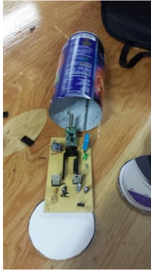
Figura 1. Prototipo de CanSat listo para integrar una tarjeta Arduino Pro mini con su tarjeta de radiocomunicaciones.
