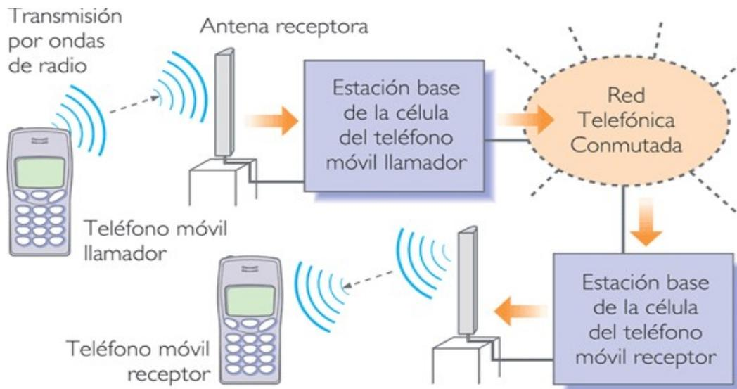
Figura 1. Esquema del funcionamiento de los teléfonos celulares al momento de una llamada( <http://aguancha1904.blogspot.mx/> a 13 de febrero 2018).
