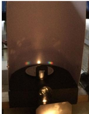
Foto 2: Espectrómetro vista completa con luz amarilla
