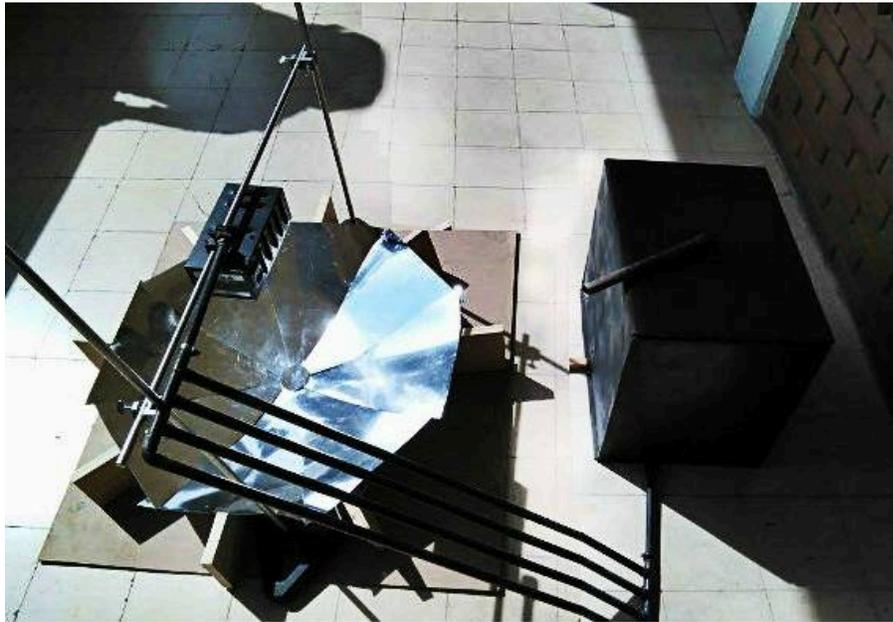
Fig.4.0 Superficie reflectora y colector del sistema.
