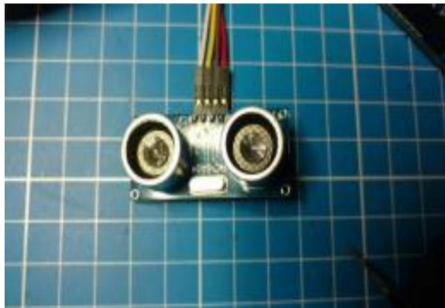
Figura 6. - Conexiones del sensor ultrasónico.
