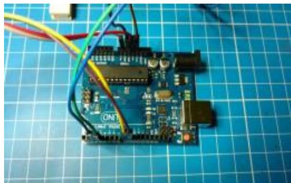
Figura 4.- Conexión del sensor ultrasónico con Arduino.
