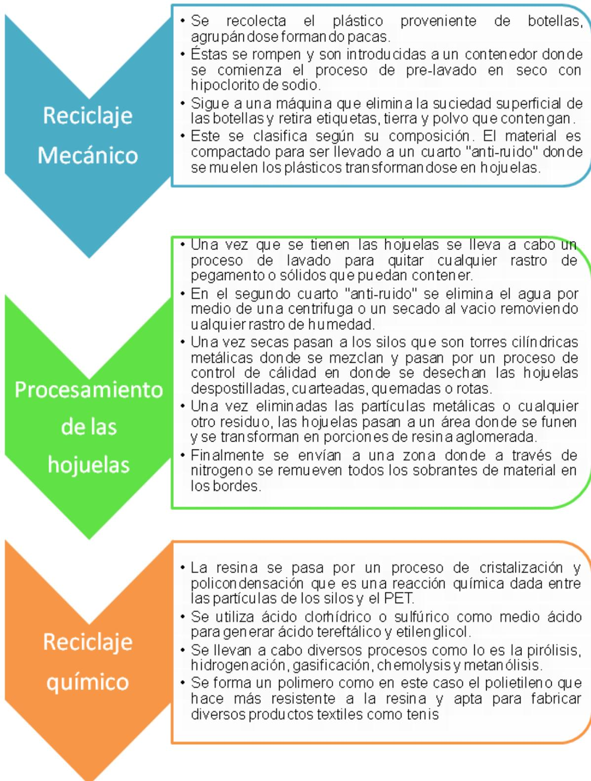
Figura 1. Proceso de reciclaje mecánico y químico del PET para convertirlo en resina. Proceso de resina a hilos de poliéster, a continuación.
