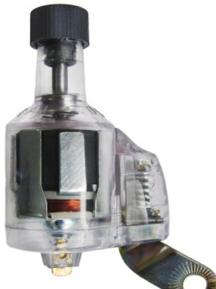
transformación de flujo magnético en electricidad mediante el fenómeno de la inducción electro magnética, generando una corriente continua. Esta transformación se consigue por la acción de un campo magnético sobre sus conductores eléctricos dispuestos sobre una armadura. Si en vez de generar energía eléctrica continua variable genera energía eléctrica alterna se denomina alternador.
