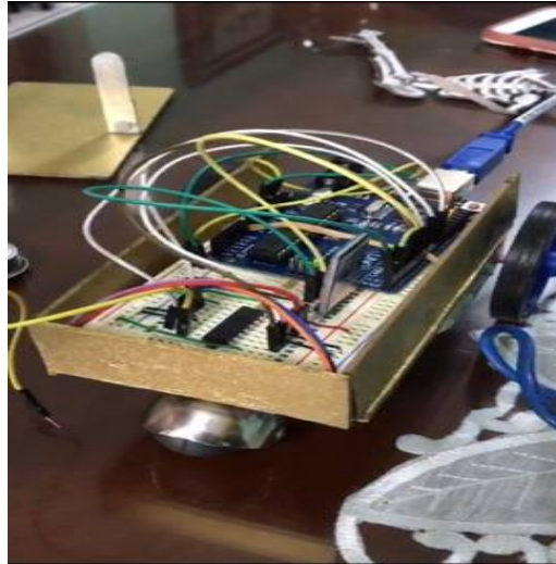
Figura 9. Circuito de silla de ruedas inteligente.
