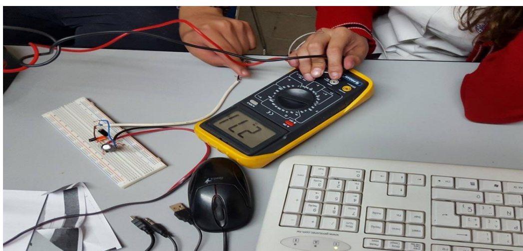
Imagen 5. Medición del nivel de voltaje.
