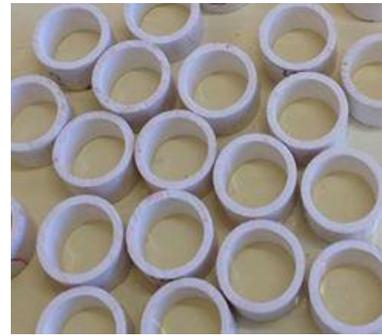
Fotografías. Donde se muestra el procedimiento que se siguió para obtener los carretes que usamos para las bobinas con tubos de PVC.
