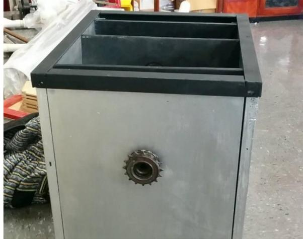
2. Se hicieron perforaciones de 5.5 cm en las tres tablas de madera internas de la caja, de medidas de 31.5 x 51 cm, de tal manera que se acomodaran en un círculo, de manera concéntrica al eje, los tres discos de bobinas, en los cuales se colocará un total de 8 bobinas por cada tabla. Dando en total 24 de ellas.
