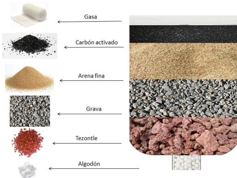
Esquema del filtro y sus componentes, Figura 1
