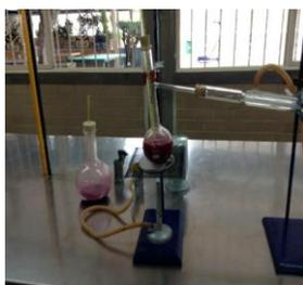
*Ilustración 2 Proceso de Destilación*
