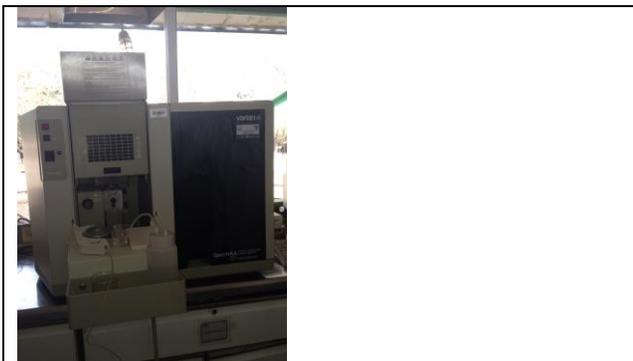
Fotografía 17. Espectrofotómetro de absorción atómica marca Varian.
