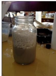
10. Una vez derretido el Unicel vaciarlo dentro del molde del ladrillo previamente forrado con papel cera, 26cm de largo, 16cm de ancho y 8cm de largo.
